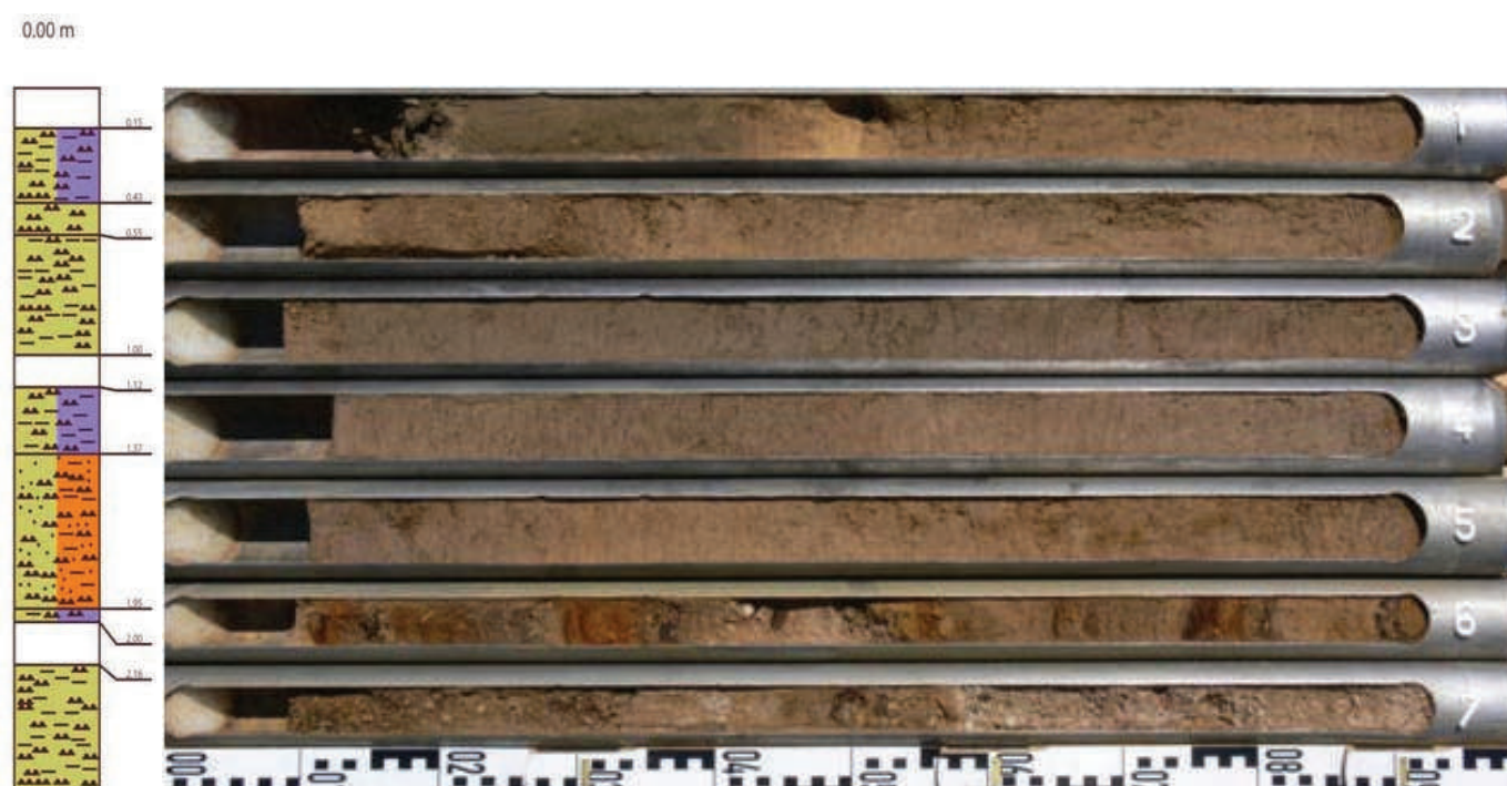
Bohrkerne aus der Talsohle; Endteufe 7 Meter
